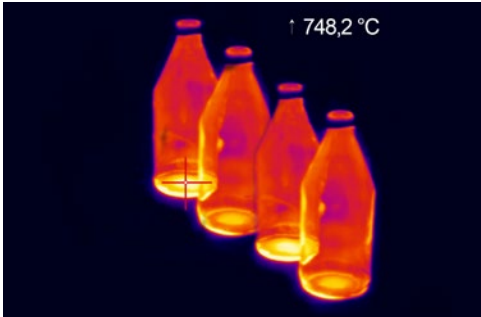
Hot-Spot-Messung bei der Herstellung von Glasflaschen
