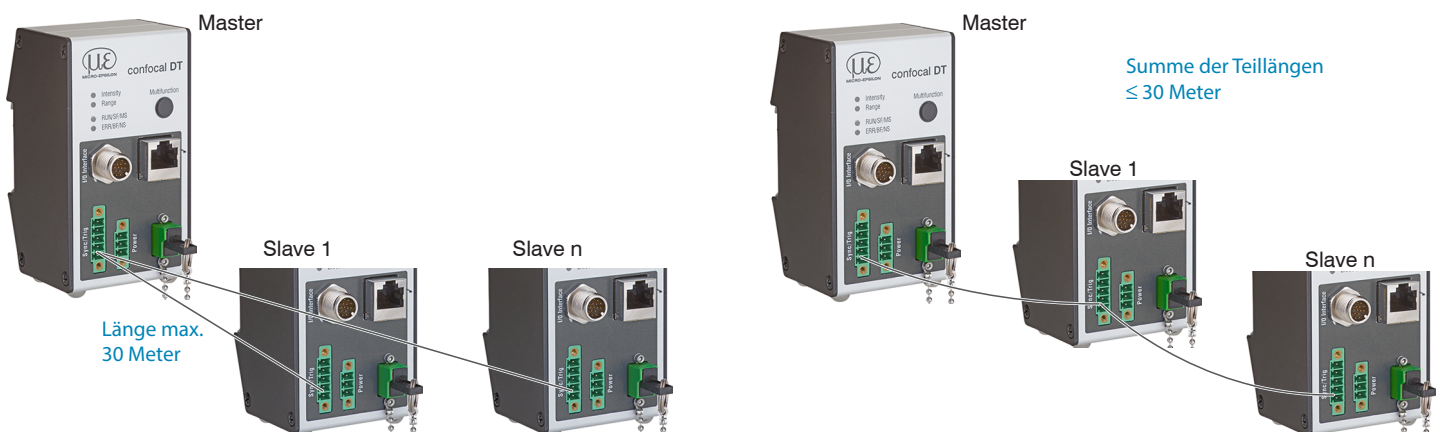
Abb. 27 Synchronisierung mehrerer Controller, links sternförmig, rechts verkettet
