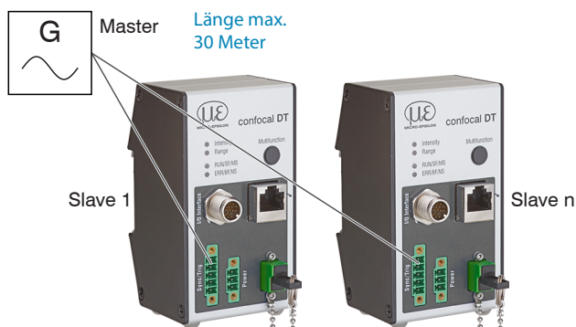
Abb. 29 Synchronisierung mehrerer Controller, sternförmig
