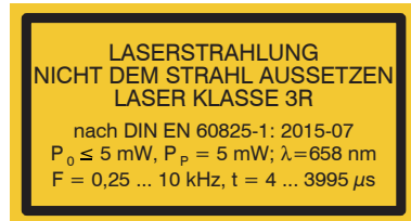
Abb. 3 Laserhinweisschilder am Sensorkabel
