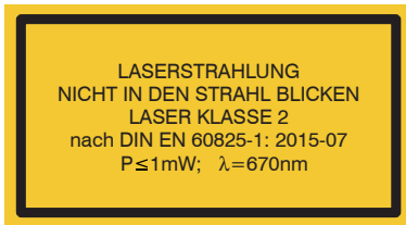
Abb. 1 Laserhinweisschilder am Sensorkabel
