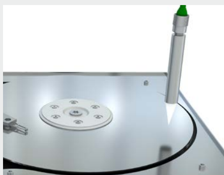
Prüfung des Axialschlags von Festplatten
