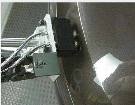
Kontrolle der Farbgleichheit bei Anbauteilen in der Automobilfertigung
