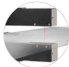
thicknessGAUGE C.L Eingesetzte Sensorik: Lasertriangulations- Wegsensoren
