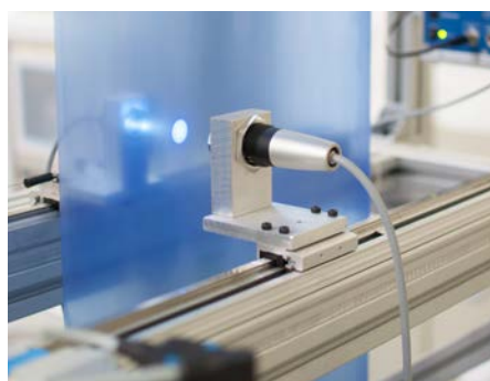
Inline Farbmessung des Farbverlaufs von transparenten Folien und Acryl-Gläsern
