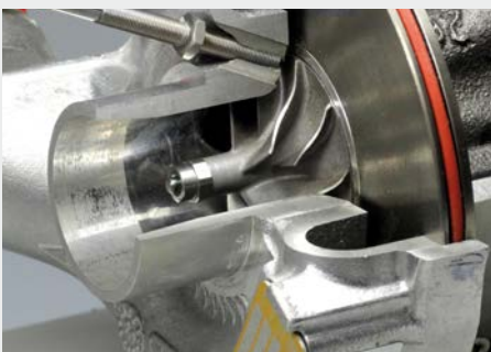
Drehzahlmessung von Turboladern
