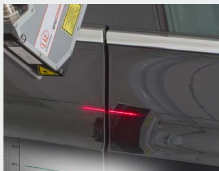
Spalt-/Bündigkeitsmessung an Karosserieteilen
