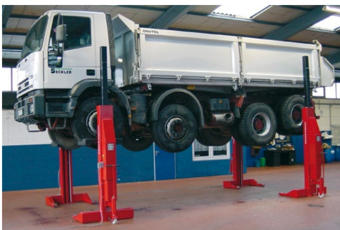
Messung der Hubhöhe im Synchronhubsystem
